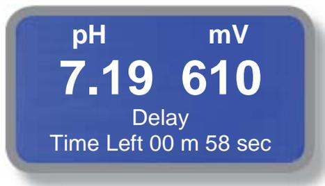
Die Startverzögerung wird als Count Down auf dem Display angezeigt.
