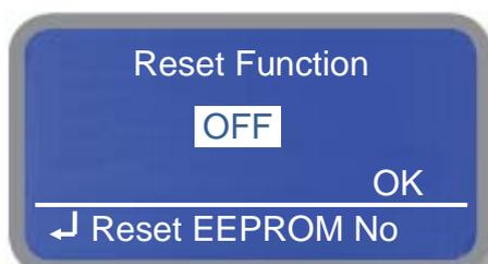
Drücken Sie im Hauptmenü das Klick-Wheel auf der Position „Instrument Reset“, um das Untermenü zu öffnen.
