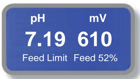
Nach Ablauf der max. Dosierzeit ohne Erreichen des Sollwertes erscheint die Meldung „Feed Limit“ unter dem betreffenden Messparameter.
